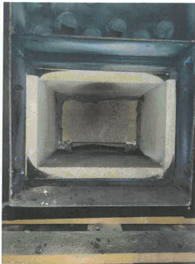
Rysunek 9 Elementy ceramiczne komory spalania
