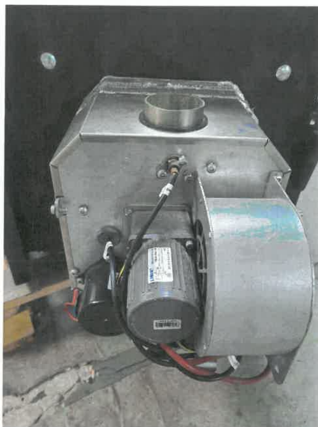
Rysunek 5 Wentylator, motoreduktor i moduł palnika
